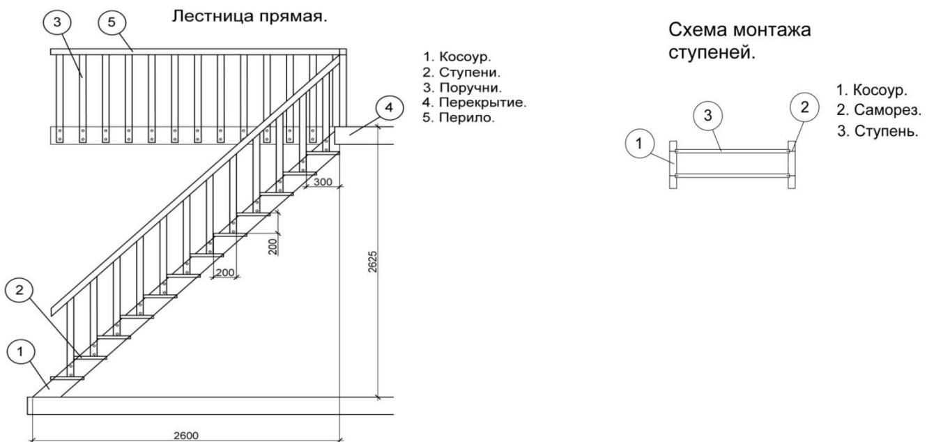
Высота ступени 200мм, ширина 300мм, шаг 200мм.
