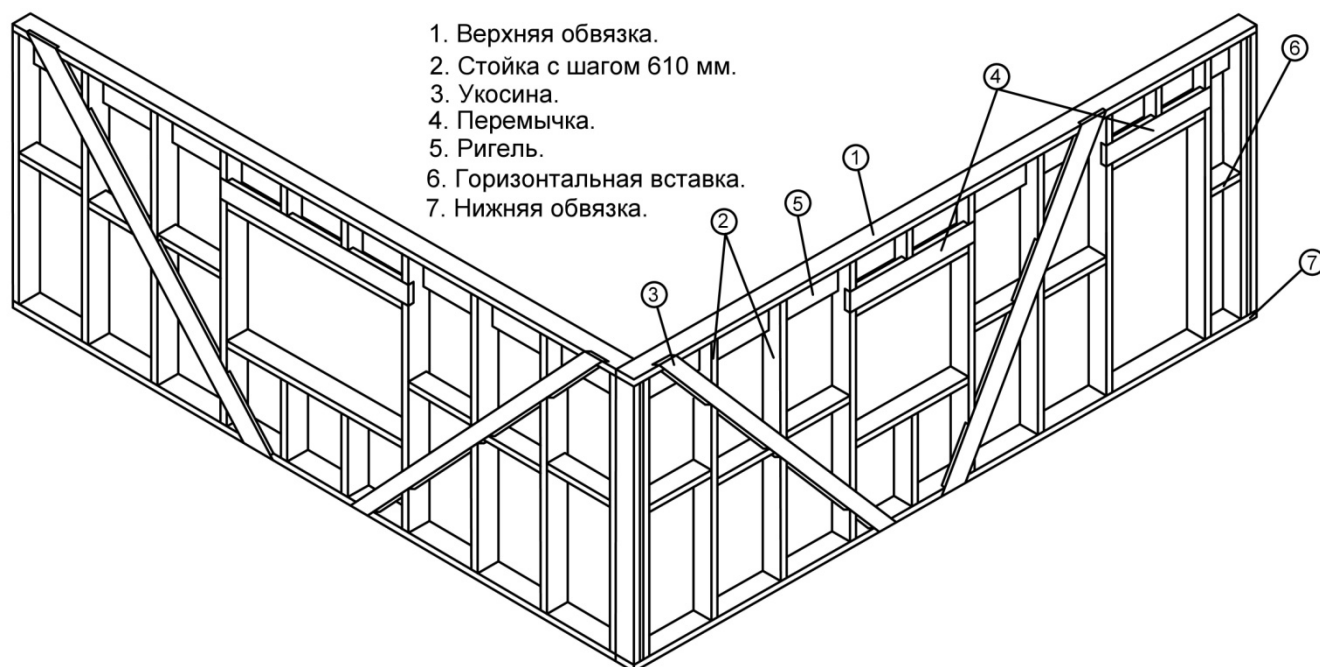
рис.9. Элементы каркаса стен
